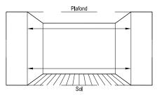
largeur\_Relever la mesure de mur à mur en 2 endroits Reporter la mesure la plus grande
